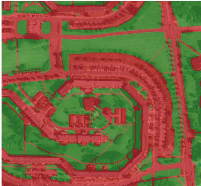
Abbildung 2: Versickerungsfähige (grün) und nicht versickerungsfähige (rot) Flächen
