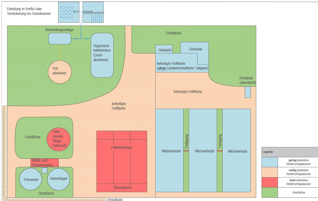
Abbildung 1: Beispielhafte schematische Flächenzuordnung auf einem LWB
